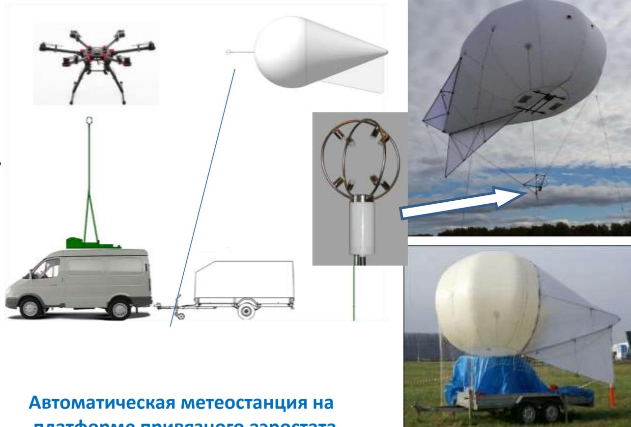
Автоматическая метеостанция на платформе привязного аэростата гибридного типа.
