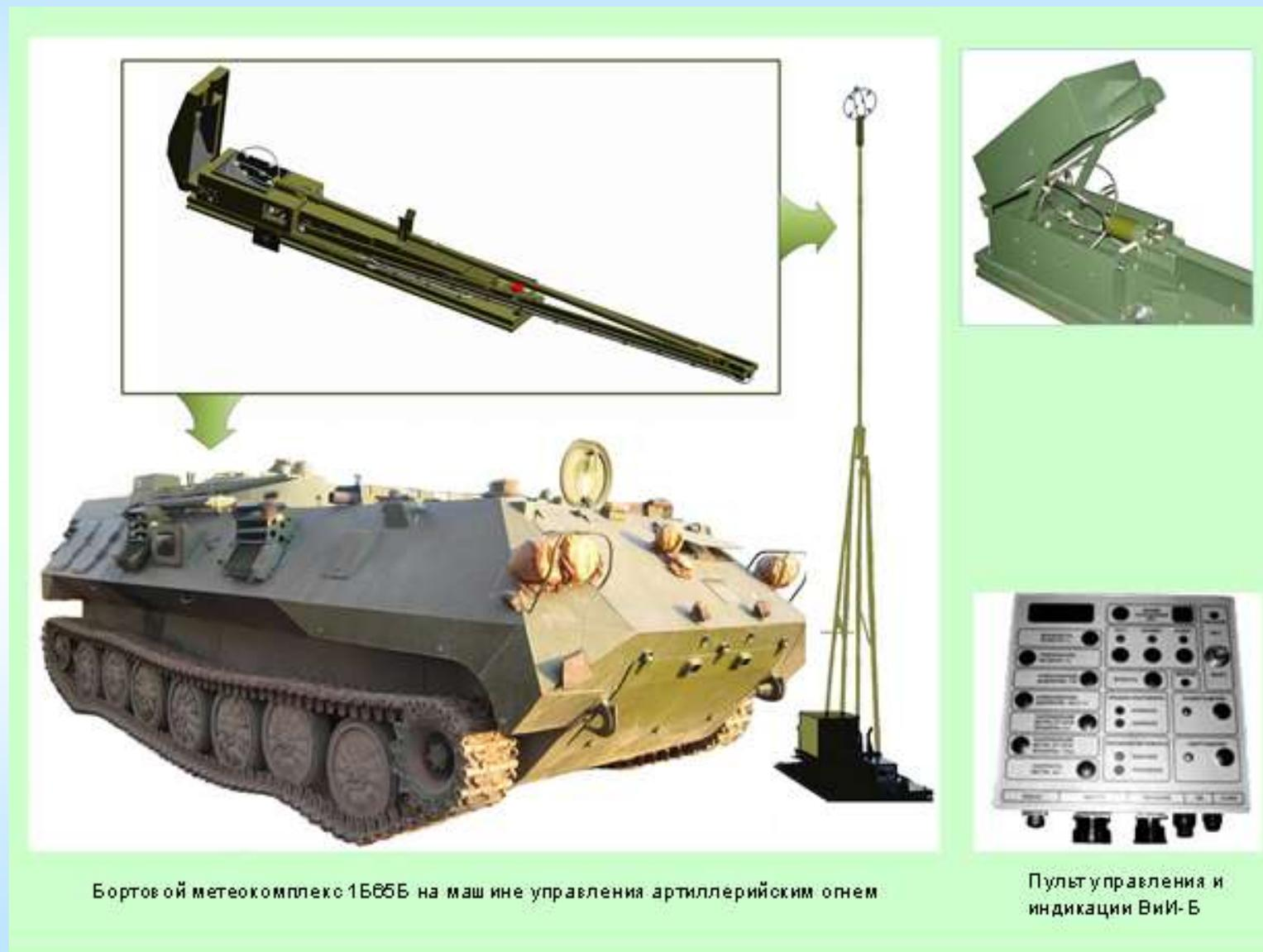
Бортовой метеокомплекс 1Б65Б на машине управления артиллерийским огнем
